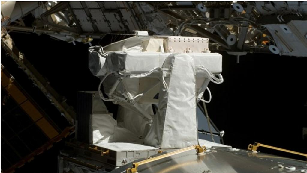
Das Instrument SOLAR ist an der Außenseite der Internationalen Raumstation ISS angebracht. Versehen mit zwei beweglichen Aufhängungen, ermöglicht es die punktgenaue Verfolgung der Sonne von der ISS aus.
