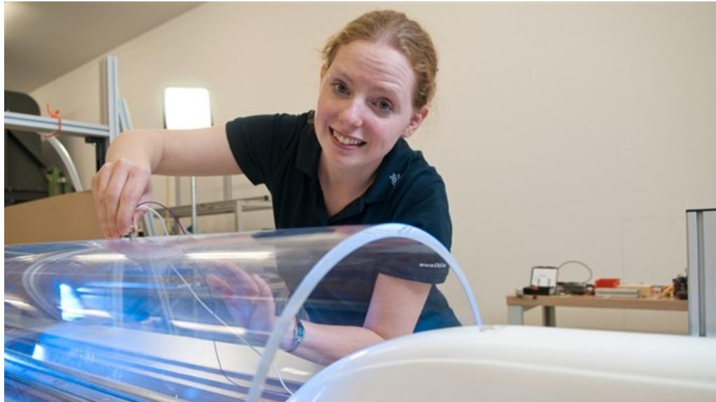
Die Physikerin Daniela Heine arbeitet am DLR-Institut für Aerodynamik und Strömungstechnik in Göttingen. Dort forscht sie in der Tunnelsimulationsanlage an Modellen von Hochgeschwindigkeitszügen. Ziel ihrer Forschung ist es die Druckwellen bei der Ein- und Ausfahrt der Tunnel zu regulieren. Damit will sie unter anderem das Taubheitsgefühl auf den Ohren der Reisenden in den Tunneln mindern.
