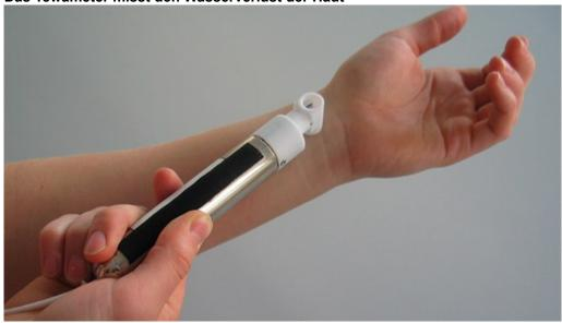
Mit dem so genannten Tewameter wird der Wasserverlust durch die Haut gemessen. Die Mess-Sonde ist Teil des ISS-Experiments SKIN B. Dieses untersucht den Einfluss der Schwerelosigkeit auf die menschliche Haut.
