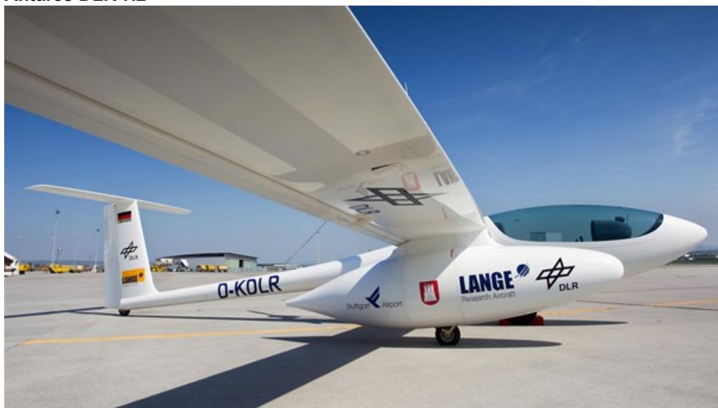
Emissionsfreies Fliegen wird Wirklichkeit: Brennstoffzellen wandeln Wasserstoff um und erzeugen so den notwendigen Strom für den Elektromotor.
