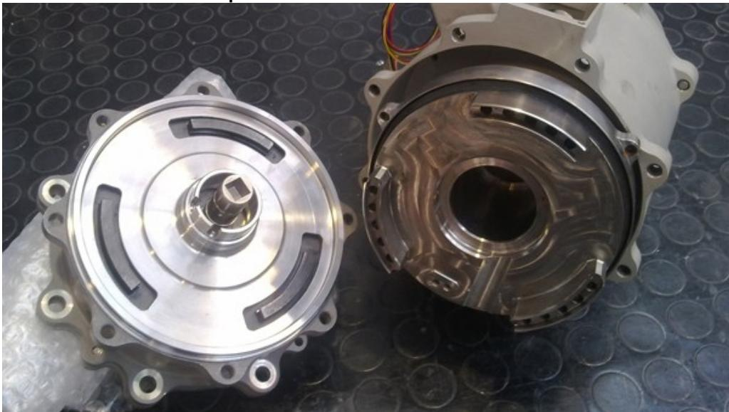
Beim A400M können Brems Scheiben mit einem Durchmesser von 120 Millimetern 5,3 Meter große Propeller innerhalb weniger Sekunden abbremsen.
