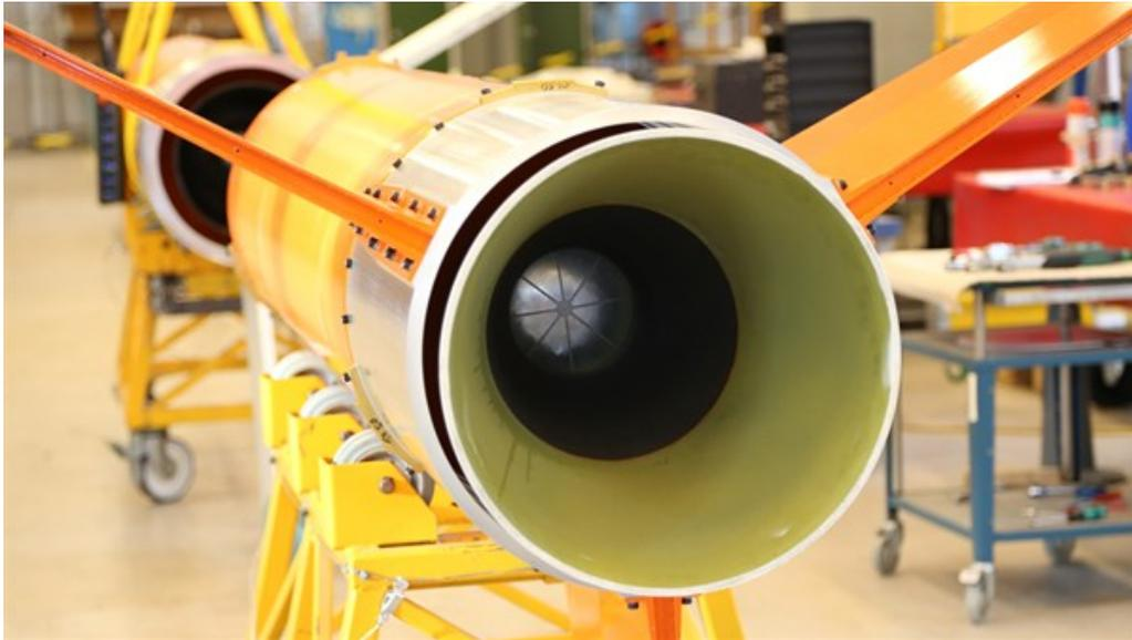
Für das TEXUS-Programm werden zweistufige brasilianische VSB-30-Raketen verwendet. Die Motoren werden von den Ingenieuren der Mobilien Raketenbasis des DLR (MORABA) für den Start vorbereitet.
