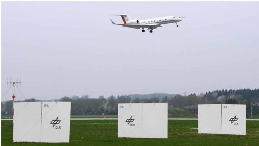
Die etwa vier Meter langen Platten verursachen Sekundärwirbel, die die Wirbelschleppen schneller zerfallen lassen.
