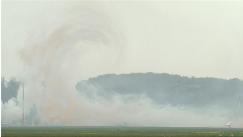
Die mächtigen Wirbel können dicht nachfolgende Maschinen empfindlich auf ihrer Flugbahn stören und auch am Boden an Gebäuden zu Schäden führen. Kleinere Maschinen sind besonders gegenüber Wirbelschleppen großer Jumbojets sensibel. Sie müssen einen erweiterten Sicherheitsabstand einhalten.
