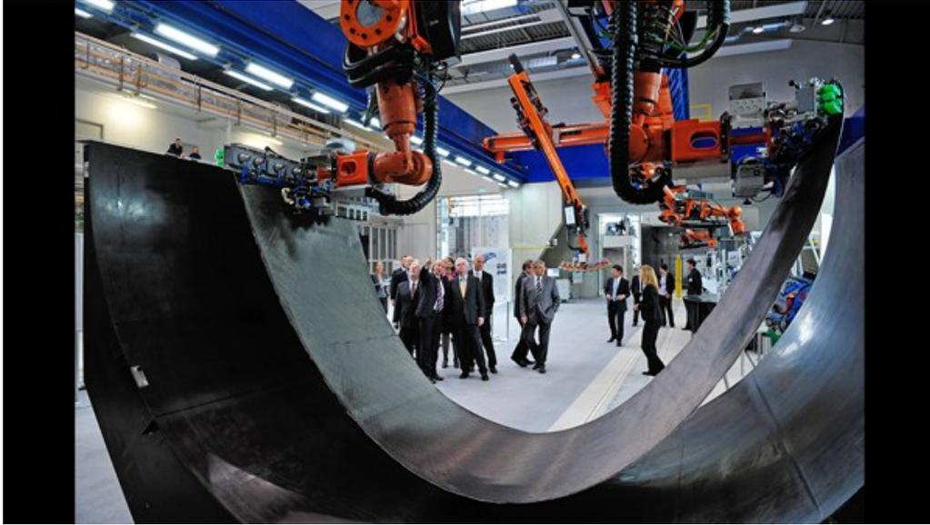
Im Anschluss an die Einweihung besichtigten die Gäste die neuen Anlagen. Herzstück des ZLP ist die "Multifunktionale Roboterzelle", die mit fünf flexiblen Roboterarmen ausgestattet ist und eine Gesamtgröße von ca. 30 Meter Länge, 15 Meter Breite und sieben Meter Höhe aufweist. Dort können unterschiedliche Produktionsprozesse auf ihre Automatisierbarkeit hin untersucht und validiert werden. Kooperierend oder allein agierend können die Leichtbau-Arme auch große Bauteile handhaben.
