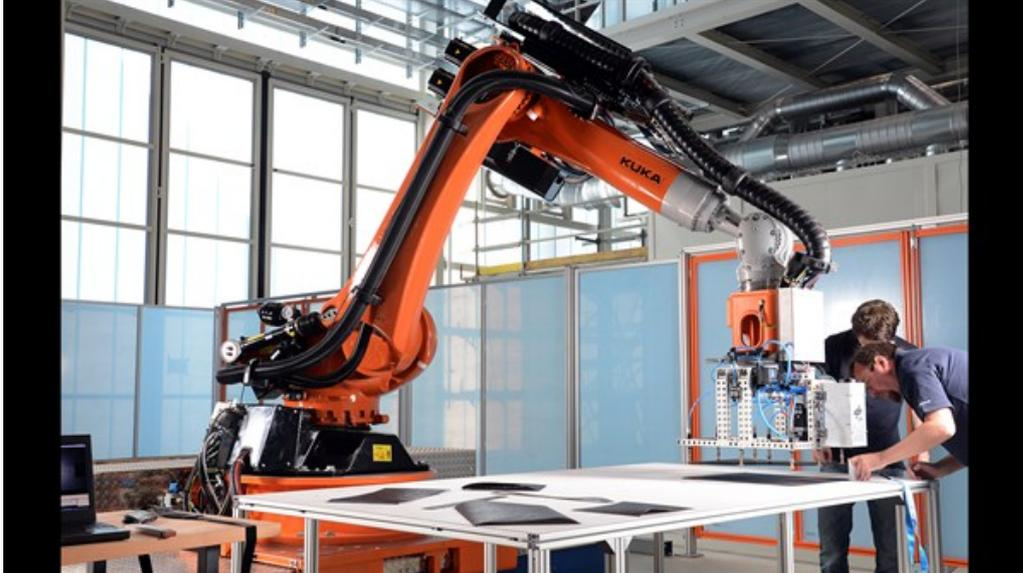
Das Robotersystem verfügt über eine besonders große Reichweite zum Greifen und Ablegen der Thermoplast-Zuschnitte.
