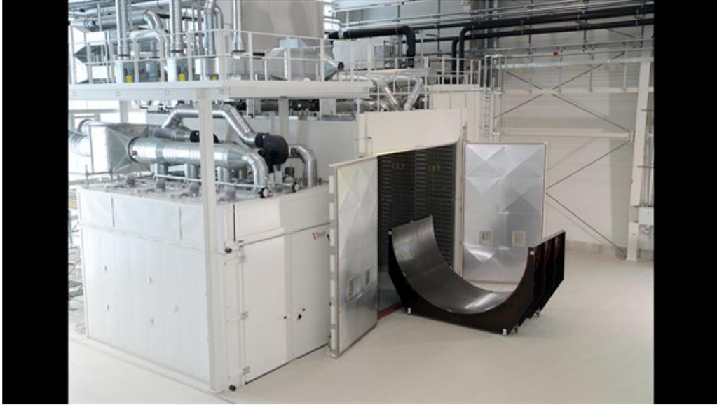
Der Thermoplastofen (links) kann mit bis zu 400°C betrieben werden. Der Duromerofen (rechts, geöffnet) eignet sich zum Härten von Harzgetränkten Stoffen und ist entsprechend für Temperaturen bis zu 210°C angelegt.
