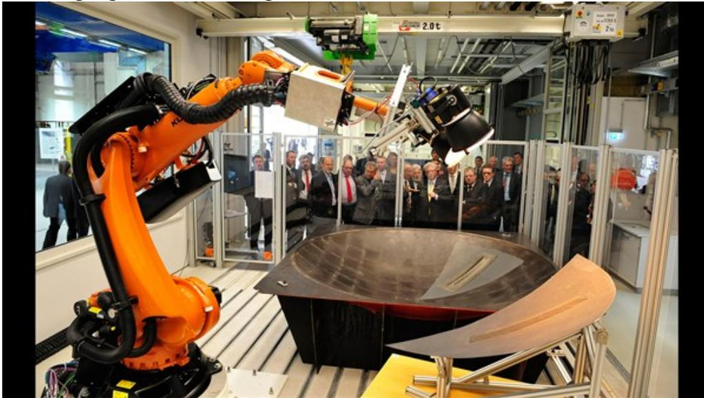
Der Rundgang führte die Delegation aus Politik, Wirtschaft und Wissenschaft unter anderem in das Qualitätssicherungslabor des ZLP. Das Labor ist mit einer Roboterzelle ausgestattet, die den DLR-Wissenschaftlern dabei hilft, die CFK-Bauteile zu überprüfen. Dieser Vorgang ist in den laufenden Produktionsprozess integriert.
