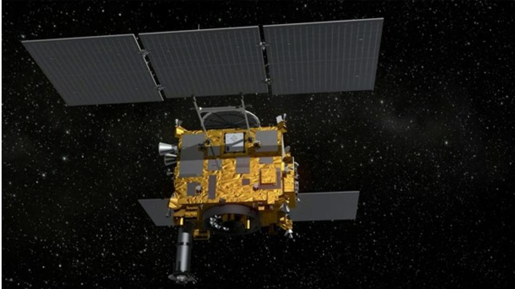
Der Asteroidenlander MASCOT fliegt mit der japanischen Raumsonde Hayabusa2 zum Asteroiden Ryugu. Dort wird er mit einem Auslösemechanismus aus der Sonde "gedrückt" und landet auf dem Asteroiden. Die vier Instrumente an Bord - ein Spektrometer der französischen Raumfahrtagentur CNES, ein Magnetometer der TU Braunschweig sowie eine Kamera und ein Radiometer des DLR - führen dann Messungen durch. Dabei hüpfert der Lander von Messstelle zu Messstelle.
