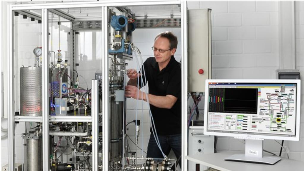
In der Umwandlung von Windstrom in Wasserstoff sehen viele Experten eine Möglichkeit, überschüssige Windenergie zu speichern. Mit einem neuartigen, beim Deutschen Zentrum für Luft- und Raumfahrt (DLR) weiterentwickelten PEM-Verfahren (Protonen Austausch Membran) kann Wasserstoff flexibel und effizient hergestellt werden.
