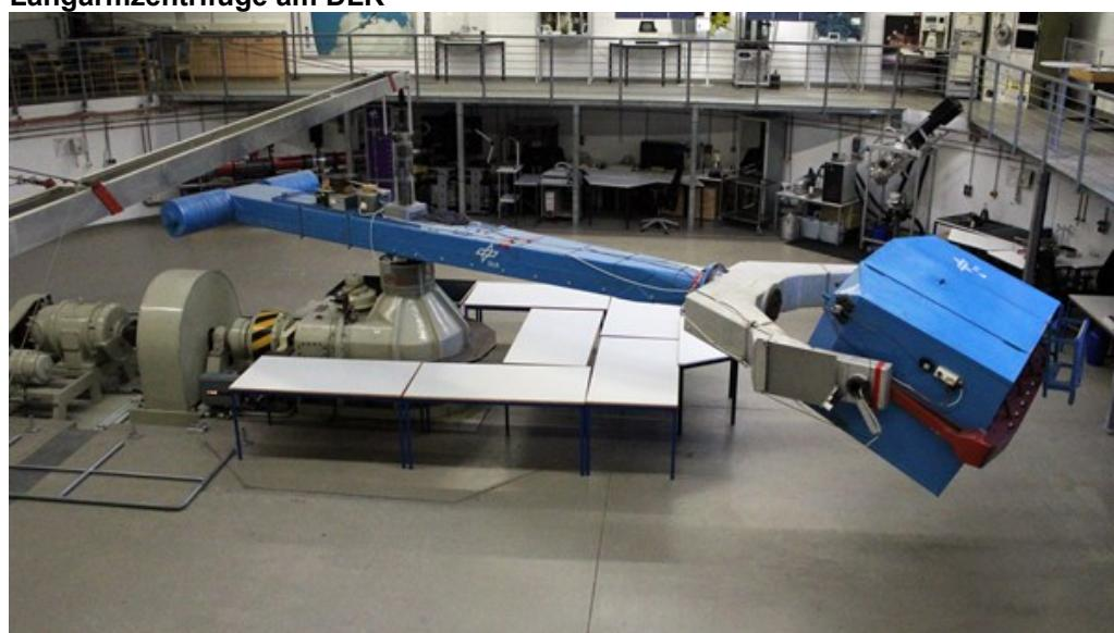
In der Langarmzentrifuge des Deutschen Zentrums für Luft- und Raumfahrt (DLR) sitzen die Probanden in einer geschlossenen Kabine an einem sechs Meter langen Arm.
