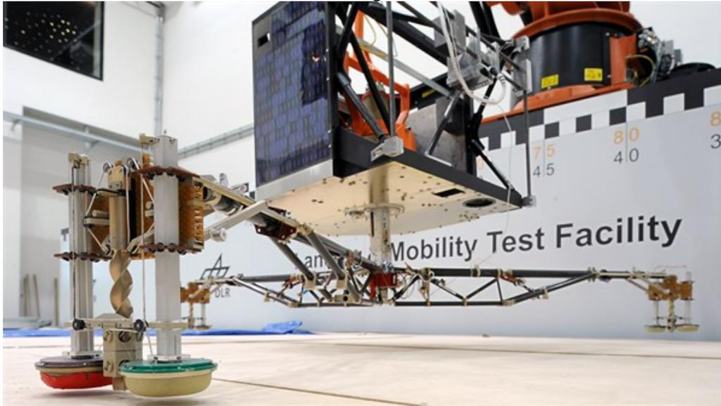
In der Testeinrichtung für Landefahrzeuge LAMA des DLR Instituts für Raumfahrtssysteme in Bremen werden die entscheidenden Sekunden des Aufsetzens eines Fahrzeugs auf einem anderen Himmelskörper untersucht. Hier ist eine Modell des Philae-Landers der Kometensonde Rosetta zu sehen, der 2014 auf dem Kometen Churyumov-Gerasimenko landen soll.
