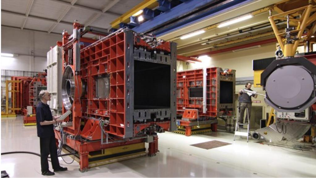
Je nach Bedarf können die fahrbaren Messstrecken des Transsonsichen Windkanals ausgetauscht werden.
