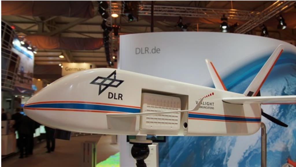
Das DLR forscht an der Kommunikation per Laser für Flugzeuge und unbemannte Flugplattformen (UAV). Im Rahmen der DLR-Ausgründung ViaLight wurde ein miniaturisiertes Laserkommunikationsterminal entwickelt. Mit Laserkommunikation können Datenraten von mehr als einem Gigabyte pro Sekunde erreicht werden, die mit konventioneller Funkübertragung nicht möglich sind.
