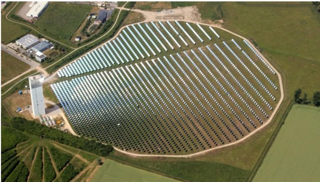
Über 2000 Spiegel reflektieren das einfallende Sonnenlicht und fokussieren es auf einen Receiver am Turm. Dort wird die Sonnenstrahlung in Wärme umgewandelt.
