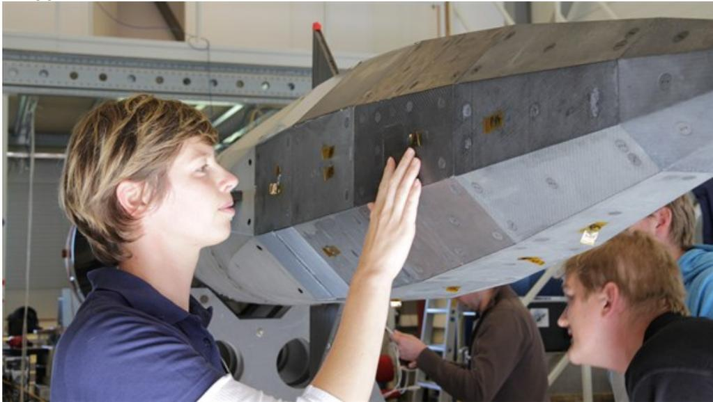
Schwerpunkt der Arbeiten der Nachwuchsgruppe ist die Analyse der Vorderkante des DLR-Rückkehrfahrzeugs SHEFEX III. Hier gilt es, eine optimale Möglichkeiten für die Kühlung zu finden.
