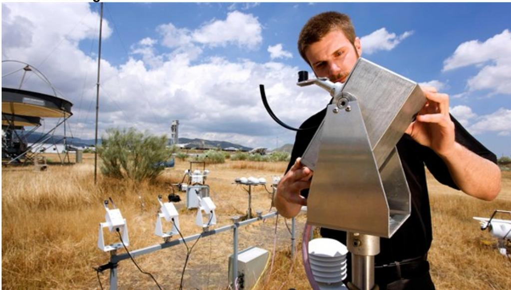
DLR-Forscher auf der Plataforma Solar de Almería in Südspanien eichen Messstationen, die für ein Messnetz in einigen Ländern in Nordafrika zum Einsatz kommen.
