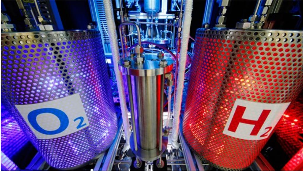
PEM-Elektrolyseure (Protonen Austausch Membran) können innerhalb von Minuten in den Volllastbetrieb hochfahren und sich so an das fluktuierende Angebot von Wind- und Solarstrom anpassen.
