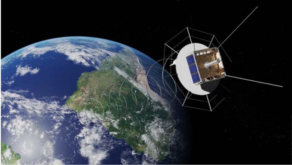
Mit einer flexiblen, 4 Meter langen Helix-Antenne soll der Satellit AISat des Deutschen Zentrums für Luft- und Raumfahrt (DLR) die Signale der Schiffe empfangen. Er soll im Sommer 2013 an Bord einer indischen Rakete starten.
