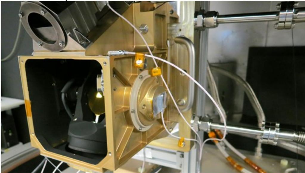
Der Scankopf wurde zum Einbau in die Thermal-Vakuum-Kammer integriert. Dort werden unterschiedliche Temperaturbereiche getestet.
