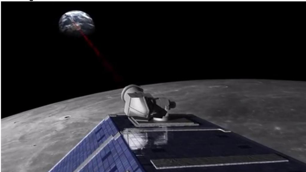
Das Lunar Lasercomm Space Terminal (LLST) an Bord der NASA-Sonde LADEE (Lunar Atmosphere and Dust Environment Explorer) sendete das Signal zur Erde. Die Wissenschaftler des Deutschen Zentrums für Luft- und Raumfahrt (DLR) analysierten den Einfluss der Erdatmosphäre auf dieses Signal.
