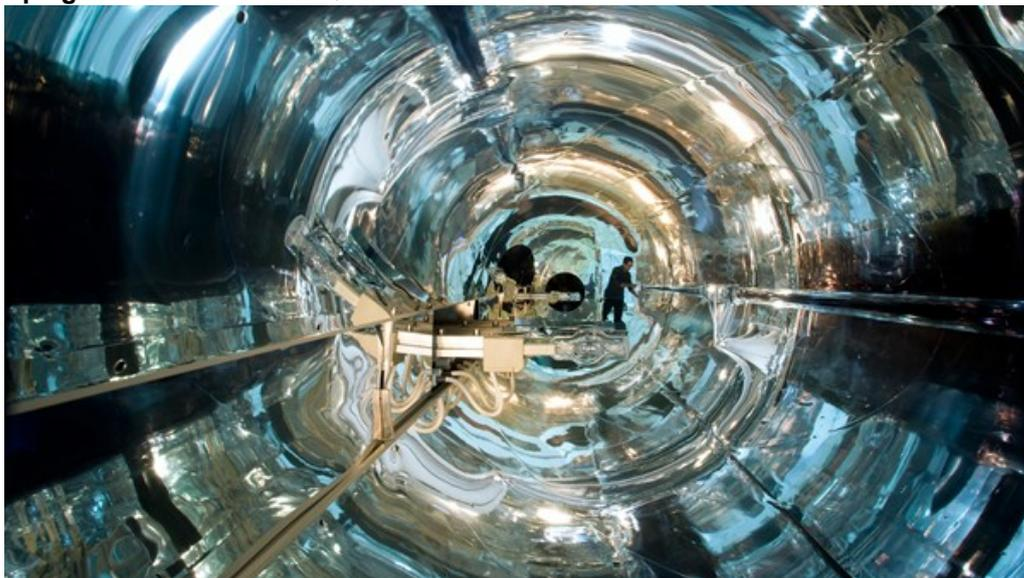
Im QUARZ-Zentrum des DLR-Instituts für Solarforschung in Köln wird die Leistungsfähigkeit von Receiver und Spiegeln für Solarkraftwerke getestet. Der mit Lampen betriebene Prüfstand
