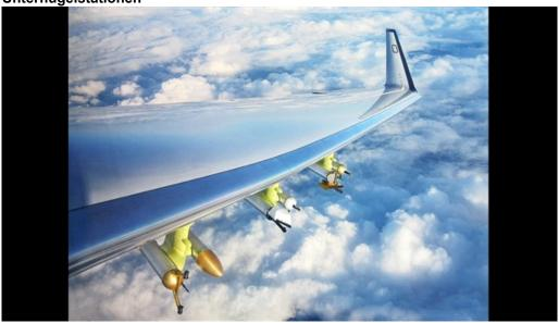
HALO fliegt mit einer der modernsten Wolken-Instrumentierungen weltweit. In den sogenannten "Unterflügelstationen" sind unter anderem PMS-Sonden - Messinstrumente für Wolkentropfen und Eiskristalle - eingebaut.
