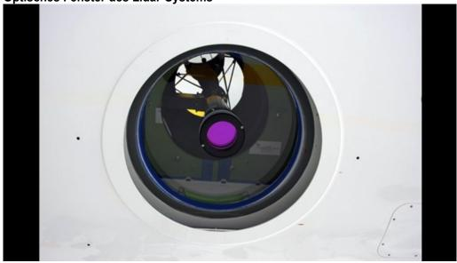
Um die Eigenschaften von Zirren und Kondensstreifen genau zu erfassen, ist Forschungsflugzeug HALO ein Lidar-System eingebaut. Hier ein Blick auf das optische Fenster von außen.
