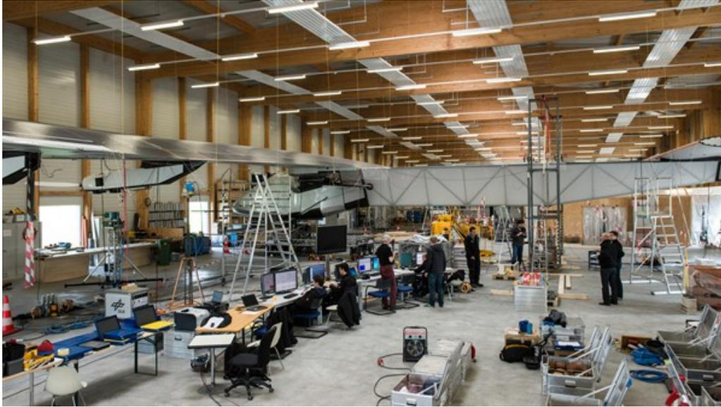
Sämtliche Kabel, die zu den Schwingungssensoren am SolarImpulse-Prototypen führen, sind über Leinen in der Luft befestigt. Das Eigengewicht der Kabel soll die sensiblen Schwingungsmessungen nicht beeinflussen.
