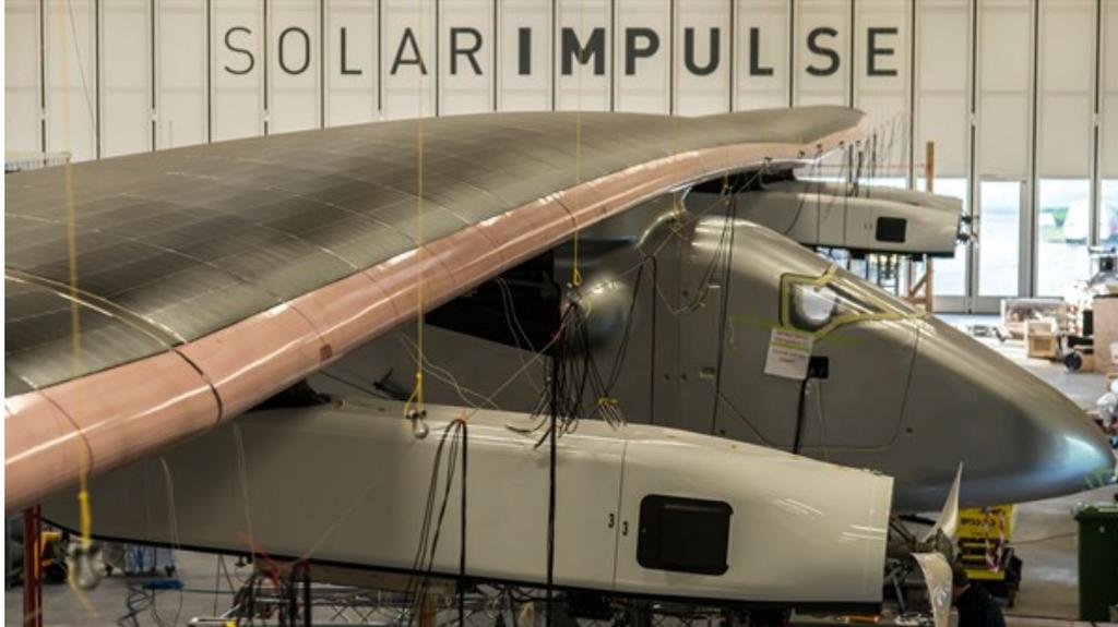
Der extreme Leichtbau des Solar-Motorseglers kombiniert mit der Flügelspannweite von 72 Metern ist für die DLR-Forscher eine besondere Herausforderung, denn die Tragflächen schwingen deutlich langsamer als bei heutigen Verkehrsflugzeugen, die in ihrer Größe vergleichbar sind.
