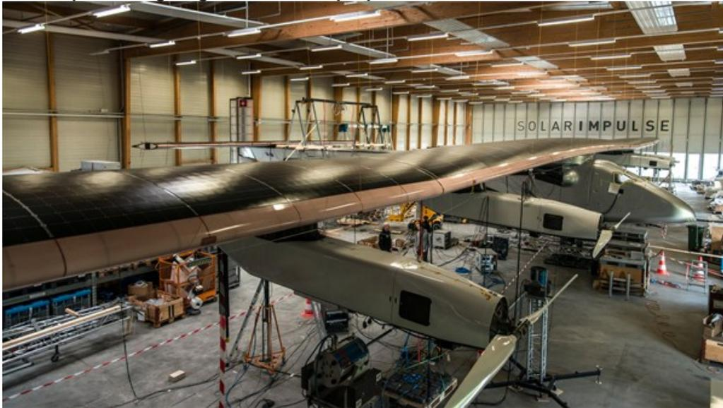
Trotz der Spannweite von 72 Metern bringt der neue SolarImpulse-Prototyp mit der Kennung HB-SIB nur rund zweieinhalb Tonnen auf die Waage. Knapp die Hälfte des Gewichts entfallen auf das Cockpit und die vier Triebwerksgondeln mit den integrierten Batterien, die das Flugzeug in der Nacht mit Strom versorgen.
