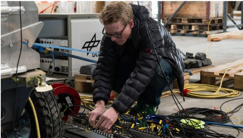
Zahlreiche Messkabel tragen die Signale der Schwingungssensoren zusammen, die über Rumpf, Tragflächen und Leitwerke des SolarImpulse-Prototypen verteilt sind. Hier prüft der Versuchsleiter Yves Govers eine Steckverbindung an einer Schnittstelle, wo die Messkabel zusammenlaufen.
