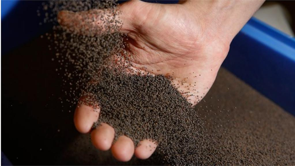
Zirka ein Millimeter große Keramikpartikel werden im Receiver direkt bestrahlt, sie sind Wärmeübertrager und Speichermedium in einem.
