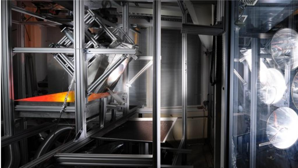
Neuartiger Receiver im Test mit Hochleistungsstrahlern am DLR-Sonnenofen in Köln
