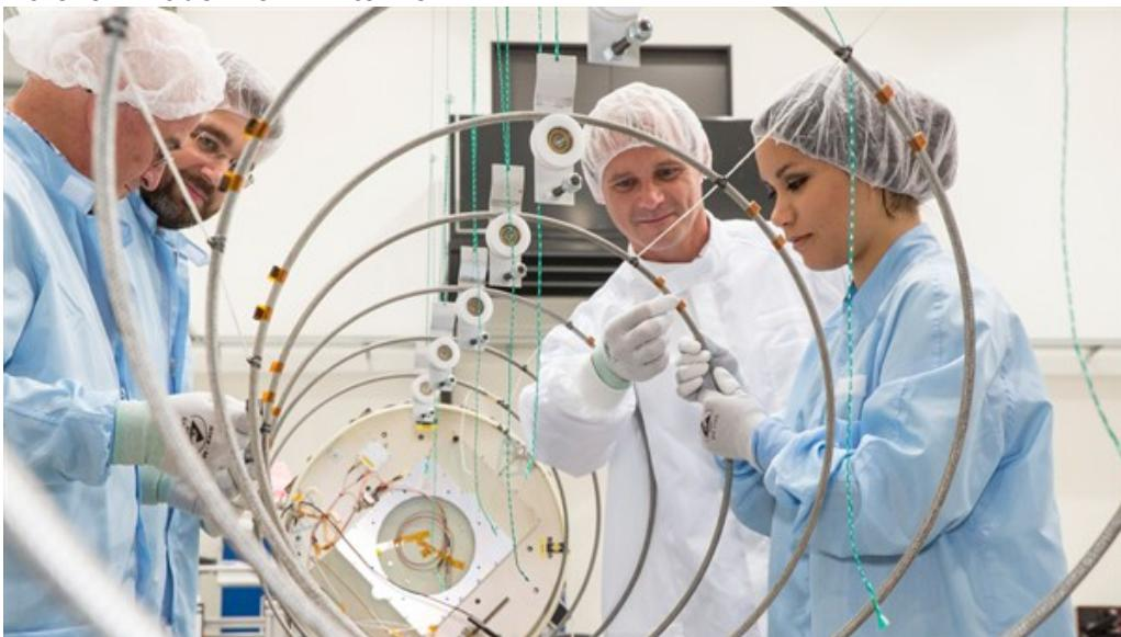
Vier Meter lang ist die Helix-Antenne, mit der der Satellit AISat des Deutschen Zentrums für Luft- und Raumfahrt (DLR) aus dem Weltall die Signale der Schiffe empfangen wird.
