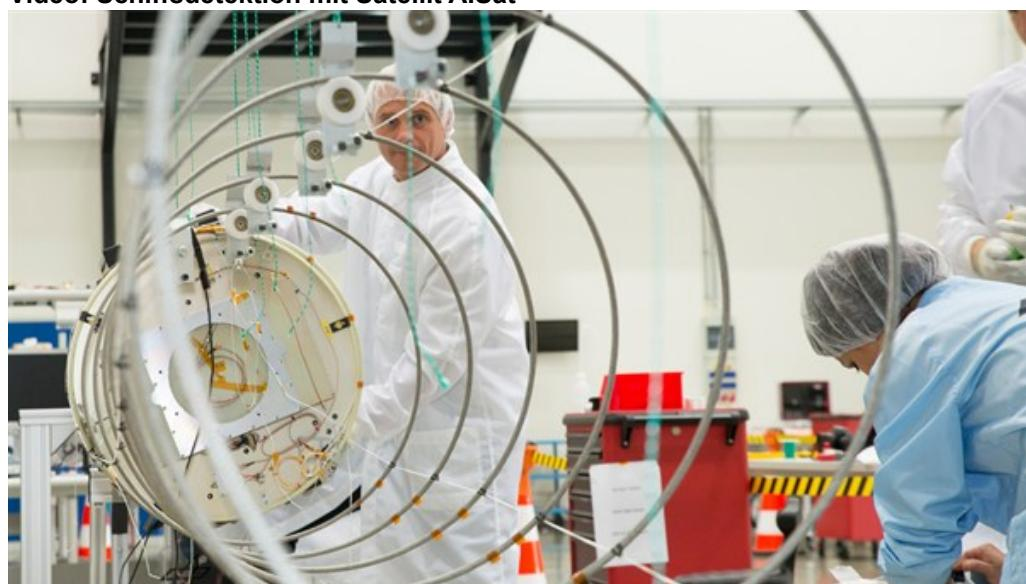
Satellit AlSat wird aus 660 Kilometern Höhe die AIS-Signale (Automatic Information System) der Schiffe empfangen. Seine Helix-Antenne ist dabei auf die Erde ausgerichtet und soll vor allem in Hochverkehrsgebieten wie der Deutschen Bucht Schiffe orten.
