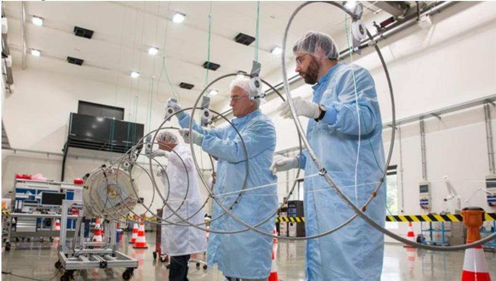
Für die Mission AISat wurden Helix-Antenne, Empfänger und Satellit vom Deutschen Zentrum für Luft- und Raumfahrt (DLR) entwickelt. Der Satellit wird aus 660 Kilometern Höhe mit einer ausgerichteten Antenne die Schiffssignale empfangen.
