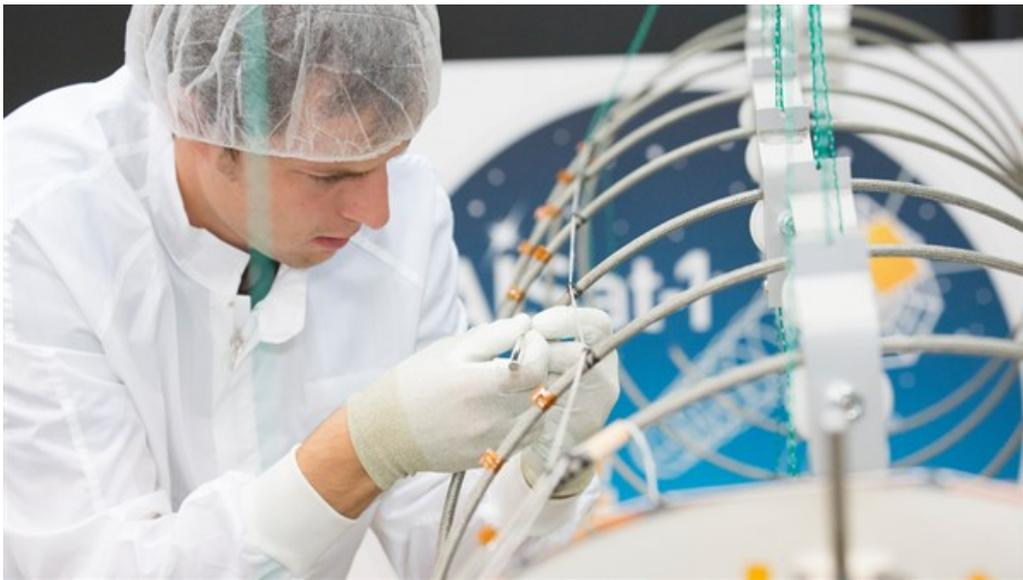
Bisher wird der Schiffsverkehr mit Satelliten überwacht, die mit einer ungerichteten Stab-Antenne ausgestattet sind und in dicht befahrenen Gebieten die einzelnen Schiffssignale kaum unterscheiden können. Für den Satelliten AISat entwickelte das Deutsche Zentrum für Luft- und Raumfahrt (DLR) deshalb eine vier Meter lange Helix-Antenne und baute für die Mission einen Satelliten sowie Empfänger. Gesteuert und betrieben wird der Satellit vom DLR-Institut für Raumfahrtssysteme in Bremen.
