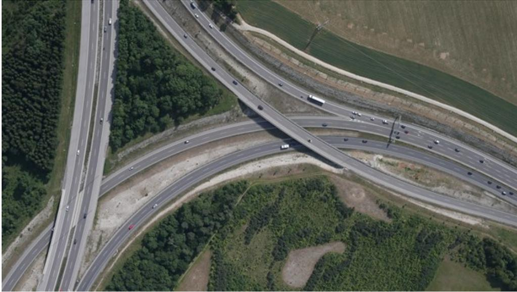
Beim Einsatz von Objektiven mit 100mm Brennweite und einer Flughöhe von 500 Metern über Grund werden Auflösungen bis zu 3.5 Zentimeter pro Bildpixel erreicht.
