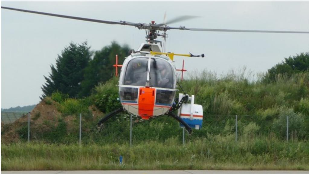
Das Kamera-System ist in einem etwa 90x60x50 Zentimeter großen Gehäuse an der linken Seite zehn Zentimeter über den Kufen des BO 105 angebracht.
