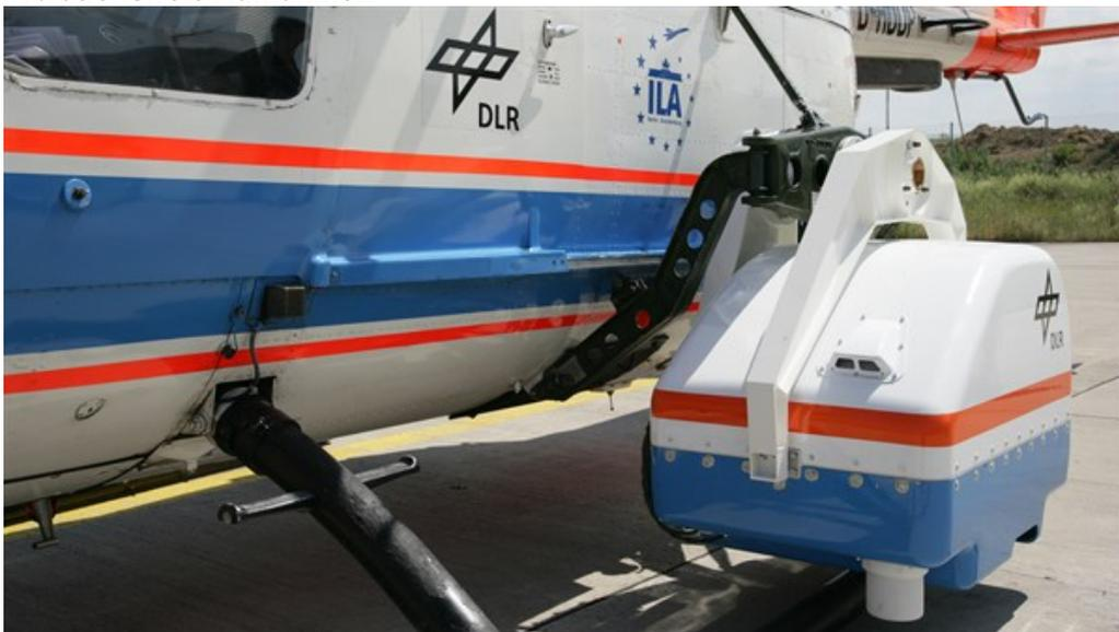
Vier Absorber im Inneren des Gehäuses koppeln das Kamerasystem von den Vibrationen des Hubschraubers ab.
