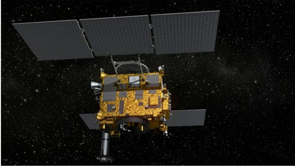
Der Asteroidenlander MASCOT fliegt mit der japanischen Raumsonde Hayabusa2 zum Asteroiden Ryugu. Dort wird er mit einem Auslösemechanismus aus der Sonde "gedrückt" und landet auf dem Asteroiden. Die vier Instrumente an Bord - ein Spektrometer der französischen Raumfahrtagentur CNES, ein Magnetometer der TU Braunschweig sowie eine Kamera und ein Radiometer des DLR - führen dann Messungen durch. Dabei hüpfert der Lander von Messstelle zu Messstelle.
