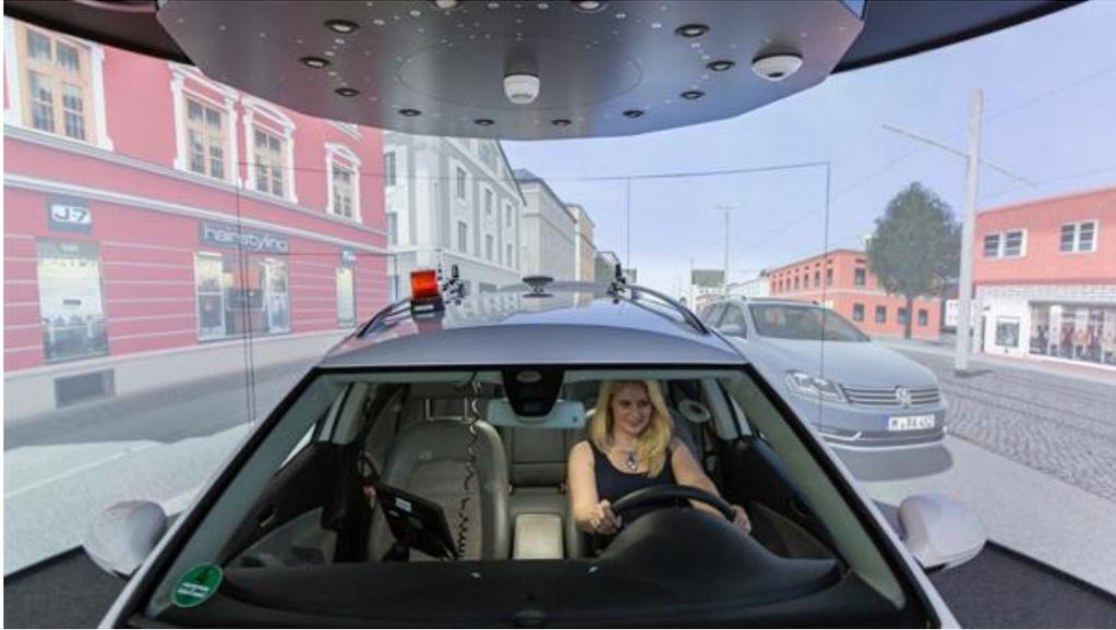
Neue Assistenzsysteme können in Verkehrssimulatoren erprobt werden.
