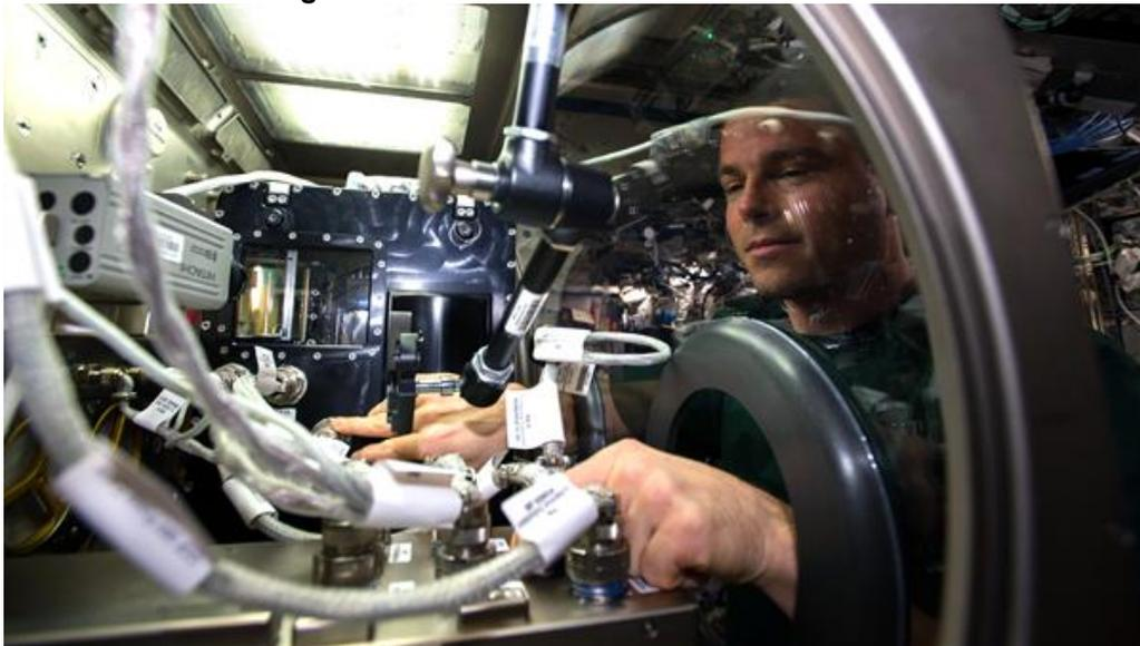
US-Astronaut Reid Wiseman installiert die CCF-Experimentanlage für die vierte Experimentserie in die Microgravity Science Glove Box der ISS.
