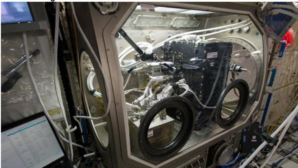
Das CCF-Experiment: Zu erkennen sind das Experimentmodul mit dem Strömungskanal (in schwarz), die Kameras, die das Signal direkt zum Boden übertragen und der Steuerungscomputer (silberfarben).
