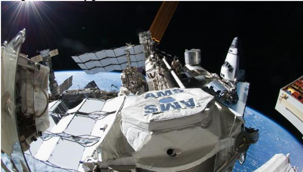
Außen an der ISS angebracht geht der Teilchendetektor Alpha-Magnet-Spektrometer (AMS) auf die Suche nach der Dunklen Materie. AMS sitzt an der Außenseite der Internationalen Raumstation ISS. Das vom Deutschen Zentrum für Luft- und Raumfahrt (DLR) geförderte Projekt zeichnet jährlich 16 Milliarden Teilchen der kosmischen Strahlung auf.
