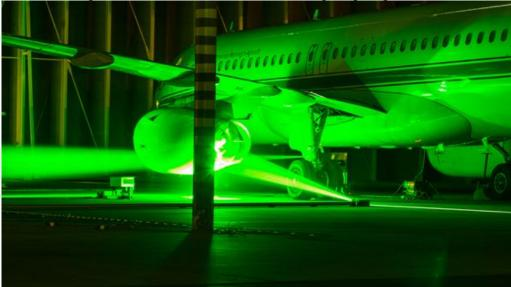
Um die turbulenten Geschwindigkeits- und Dichteschwankungen in der Strömung hinter dem Triebwerk sichtbar zu machen, haben die Wissenschaftler optische Messsysteme, die im wesentlichen mit Spezialkameras und Lasern arbeiten, mit einer Anordnung von Mikrofonen synchronisiert.
