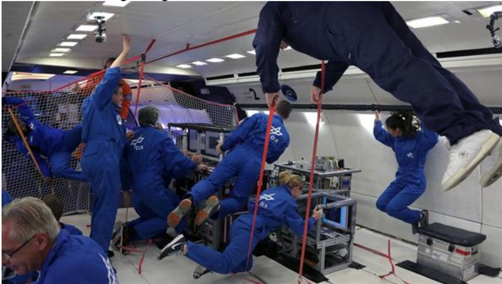
Mit der TEMPUS-Anlage werden auf DLR-Parabelflügen Proben in Schwerelosigkeit geschmolzen und wieder erstarrt. Die Daten sollen dazu dienen, Schmelzprozesse auf der Erde in der Zukunft noch effektiver zu steuern.
