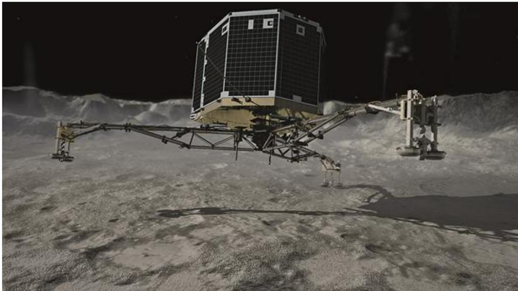
Es ist ein kurzer, aber bedeutender "Rumms", den das Instrument CASSE bei der ersten Landung von Philae auf dem Kometen Churyumov-Gerasimenko aufzeichnete - das Zwei-Sekunden-Stück aus dem All dokumentiert nicht weniger als den allerersten Bodenkontakt eines menschengemachten Objekts mit einem Kometen. Die Sensoren sitzen in allen drei Füßen des Landers und lauschten am 12. November 2014 bereits im Anflug auf den Kometen.
