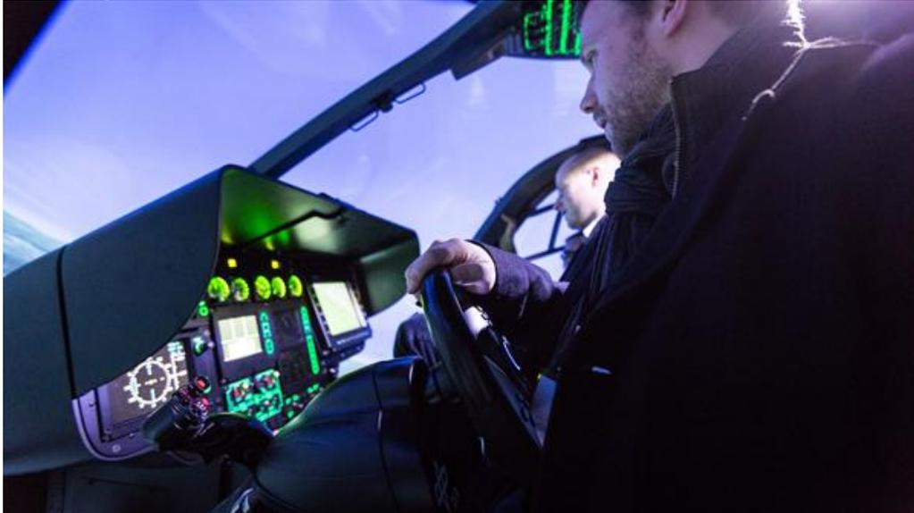
Die neue Lenkradsteuerung für Hubschrauber vereinfacht das Fliegen deutlich. Sie kann nicht nur für ein PAV genutzt werden, sondern auch andere Luftfahrzeuge verbessern.
