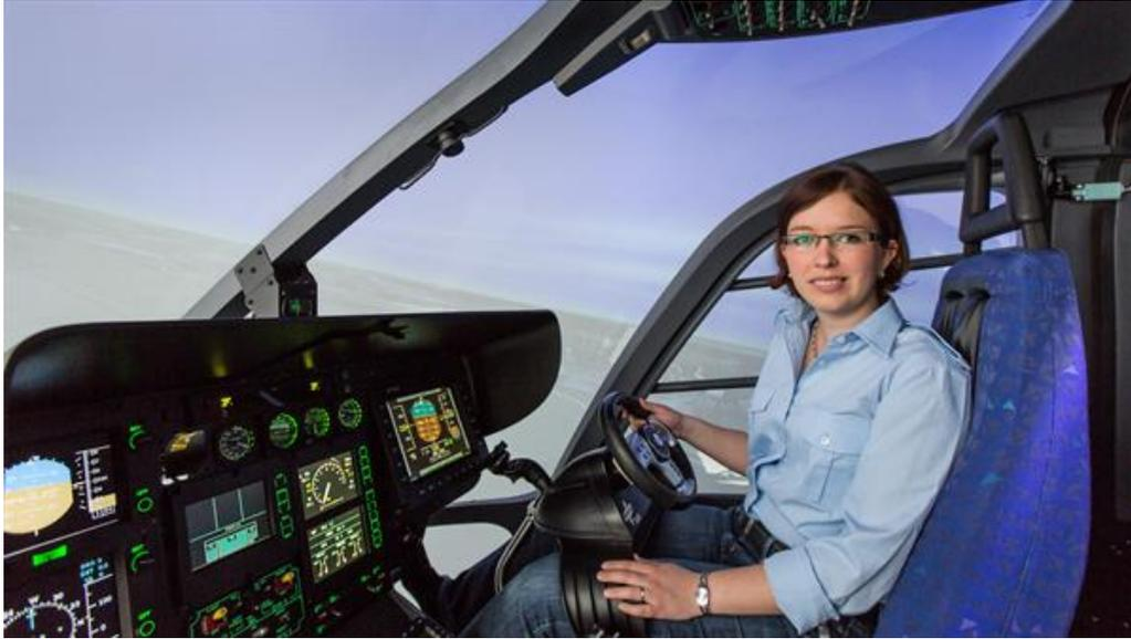
Mit der myCopter-Lenkradsteuerung lassen sich Drehflügler nahezu wie ein heutiger PKW steuern.
