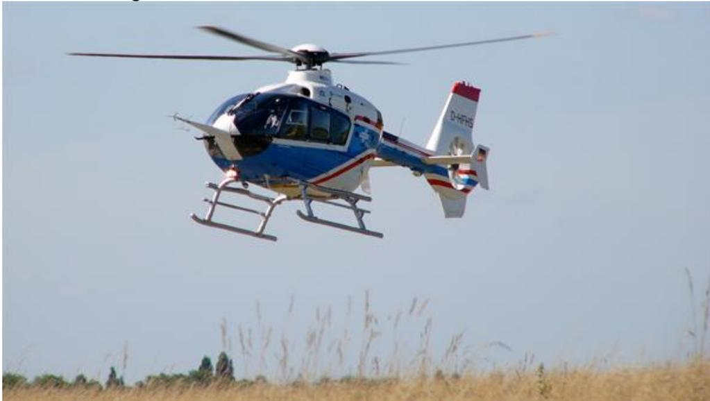
Der "Fliegende Hubschrauber-Simulator" ACT/FHS des Deutschen Zentrums für Luft- und Raumfahrt (DLR) basiert auf einem Serienhubschrauber des Typs Eurocopter EC 135, der für die Verwendung als Forschungs- und Versuchsgerät erheblich modifiziert wurde.
