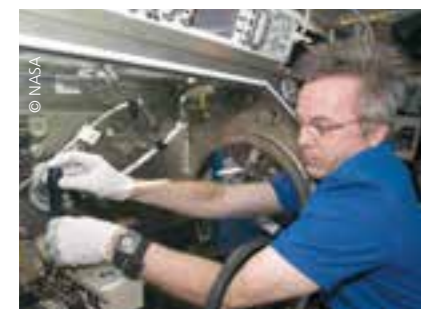
Der kanadische Astronaut Robert Thirsk installiert die SODI-Apparatur in der Microgravity Science Glovebox (MSG) im Columbus-Modul der ISS. Der deutsche ESA-Astronaut Alexander Gerst hat in dieser Anlage das Verhalten von Fluiden in Schwerelosigkeit untersucht.
