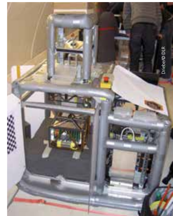
Landen auf einem Asteroiden: Die deutsche Landeeinheit MASCOT soll auf dem Objekt 1999JU3 landen, über seine Oberfläche „hüpfen“ und dabei wertvolle Informationen über den Gesteinsbrocken sammeln. Auf Parabelflügen wurde mit einem MASCOT-Modell das „Hüpfen“ geübt. Die MASCOT-Testeinheit ist im linken unteren Rack zu sehen.
