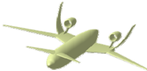
Abbildung 6: Im Projekt für Abschattungsrechnungen herangezogene lärmarme Flugzeugkonfiguration (DLR-Entwurf LNA1)
