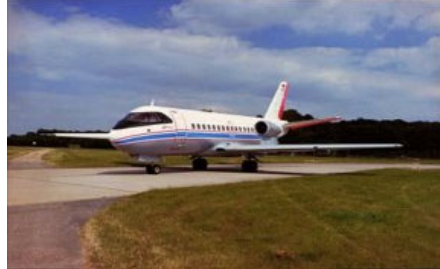
Versuchsflugzeug DLR Braunschweig: VFW 614 umgebaut zum "Advanced Technologies Testing Aircraft System" (ATTAS)
