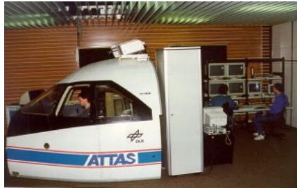
Festsitz-Simulator zur Auslegung und Vorerprobung von Flugexperimenten
