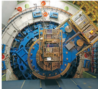
Das Ferninfrarot-Spektrometer GREAT ist auf der Gegenseite in der Druckkabine an den Teleskopflansch angeschlossen. Während des Fluges bewegt sich GREAT in einem Winkelbereich von plus/minus 20 Grad aus der Senkrechten.
