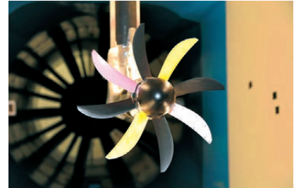
Propeller mit druck- (magenta) und temperatur-sensitiver (gelb) Beschichtung im Windkanal
