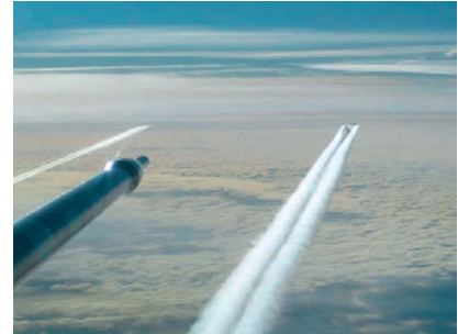
Falcon-Messungen der Mikrophysik und optischen Dicke von Kondensstreifen einer A340
