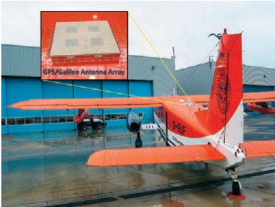
Flugversuche mit robustem Mehrantennen-GPS/Galileo-Empfänger des DLR
