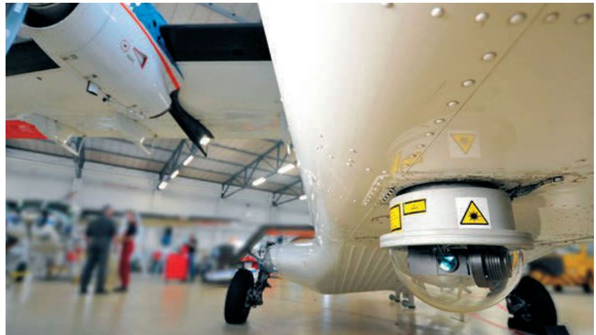
Am Rumpf des DLR-Forschungsflugzeugs Do228-212 ist der Außenanbau des Laserterminals festgeschraubt
