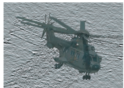
Hauptrotorwirbelbahnen bei einem Eurocopter Cougar Hubschrauber im langsamen Vorwärtsflug
