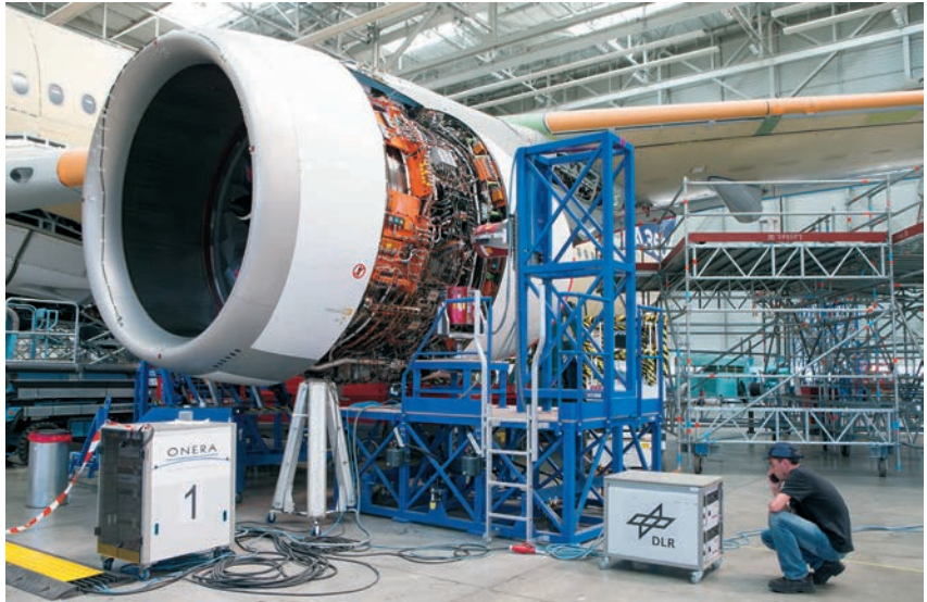
Standschwingungsversuch am Airbus A350 XWB
