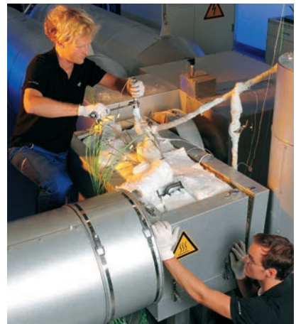
Testanlage für thermochemische Speicher
