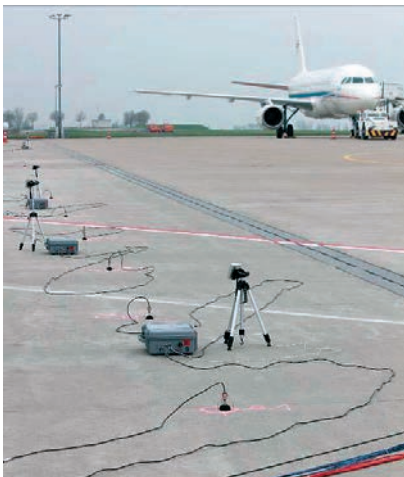
Mikrofonarray und Einzelmikrofone zur Vermessung der Triebwerksströmung
