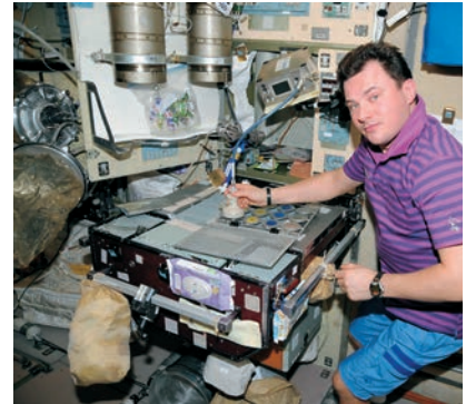
Elektronischer Gas-Sensor E-Nose zur Detektion mikrobieller Kontaminationen auf der Internationalen Raumstation ISS
