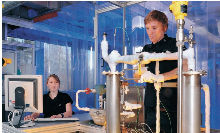
Laborteststand zur Wärmetransformation für einen Temperaturbereich von 80-200 °C
