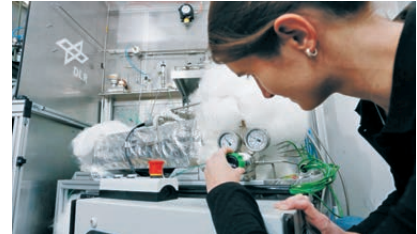
Versuchsanlage des Wasserstofftanks
