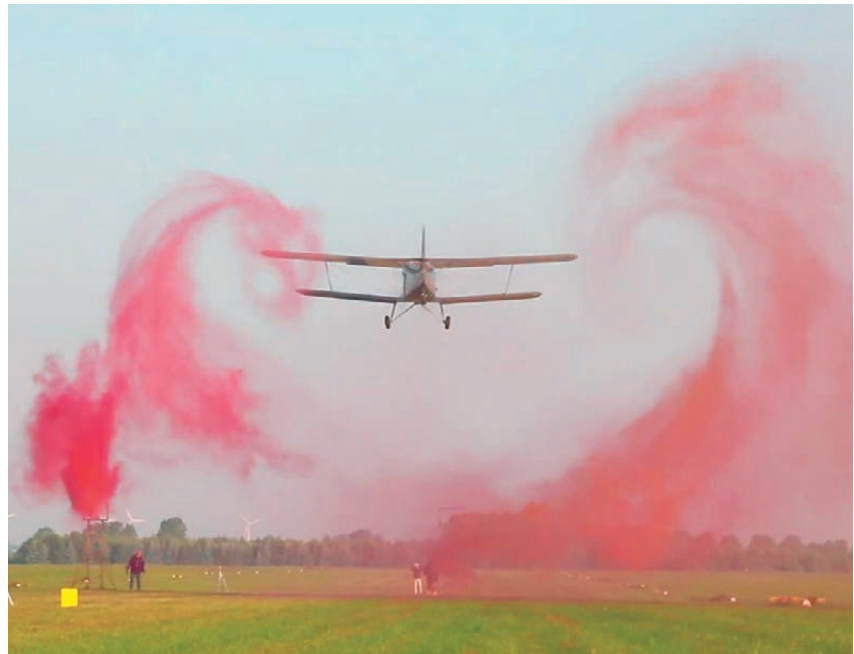
Sichtbarmachung des Wirbelaufrollens nach AN-2-Bodenüberflug
