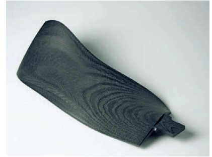
Erste gefertigte CFK-Fanschaufel, auf deren Oberfläche sich die Konturen der Einzellagen abzeichnen
