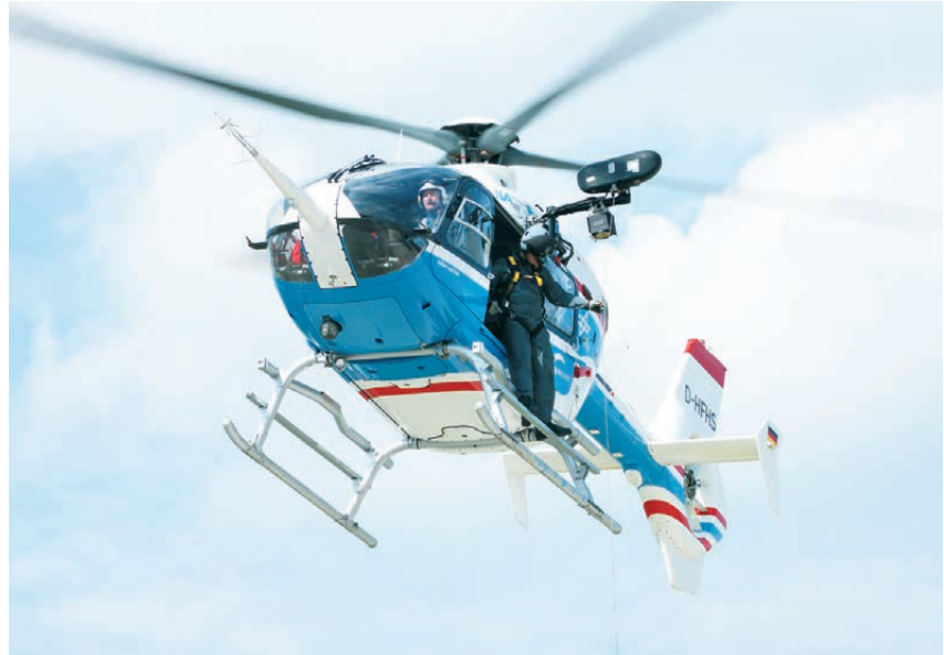
ACT/FHS mit Rettungswinde und Sensor zur Erfassung der Lastpendelbewegung (Sensor am Windenarm)
