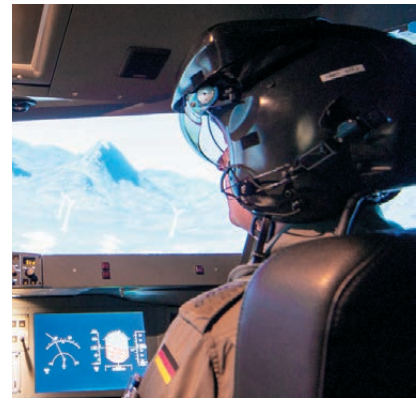
Das HMD im generischen Cockpitsimulator GECO mit kollimierter Außensicht und Center-Stick für die Hubschrauber-Simulation.
