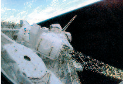
SRTM-Instrument mit Mast in der Ladebucht des Space Shuttle
