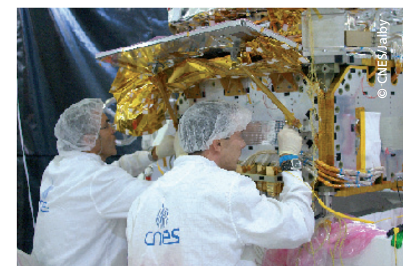
Zusammenbau des CoRoT-Satelliten bei Intespace, Toulouse.
