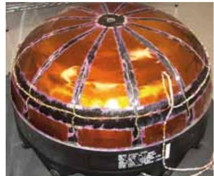
Die in diesem Tank mitgeführten 450 Kilogramm des Edelgases Xenon reichen für etwa 50.000 Betriebsstunden aus.
