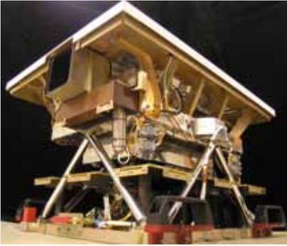
Das abbildende Spektrometer VIR (Visual and Infrared Spectrometer) des nationalen italienischen Instituts für Astrophysik (INAF) und der italienischen Raumfahrtagentur ASI. *The imaging spectrometer VIR (Visual and Infrared Spectrometer) of the National Italian Institute of Astrophysics and the Italian Space Agency ASI.*
