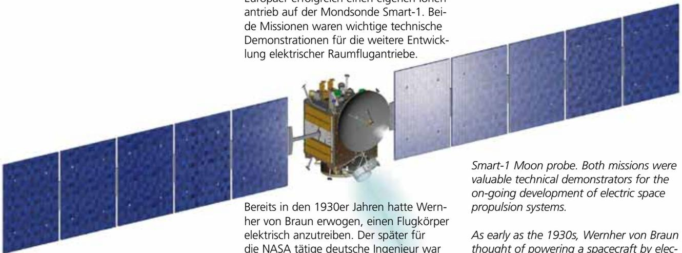
Das Ionentriebwerk von Dawn verbraucht maximal 2.500 Watt. Zur Erzeugung des Stroms in bis zu 420 Millionen Kilometern Sonnenentfernung hat die Sonde große Solarpaneele mit einer Spannweite von 20 Metern.
