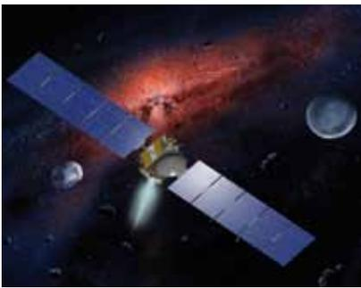
Die Raumsonde Dawn, hier in einer künstlerischen Darstellung neben Vesta und Ceres gezeigt, wird von einem Ionentriebwerk solar-elektrisch angetrieben.
