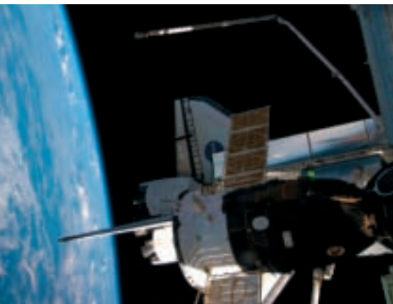
Angedockte Space Shuttles oder Progressfrachter können die ISS anheben
