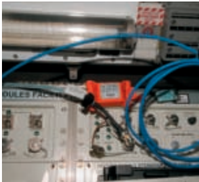
DOSIS misst die Strahlenbelastung der Astronauten an zehn verschiedenen Stellen im COLUMBUS-Labor
