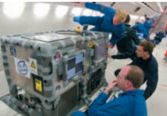
Während eines Parabelflugs an Bord des Airbus A300 Zero-G fanden Eignungstests und ergänzende Untersuchungen an der PK-4-Anlage statt
