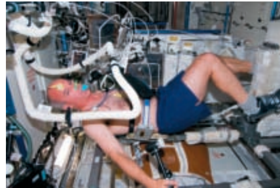
Astronaut Dave Williams misst während eines leistungsphysiologischen Tests auf der ISS kontinuierlich die Körperkerntemperatur mit dem Doppelsensor (gelb) am Kopf. Die Daten werden im Thermolabsystem (silberne Box am Gürtel) aufgezeichnet, danach ausgelesen und per Downlink an die Bodenstation geschickt.
