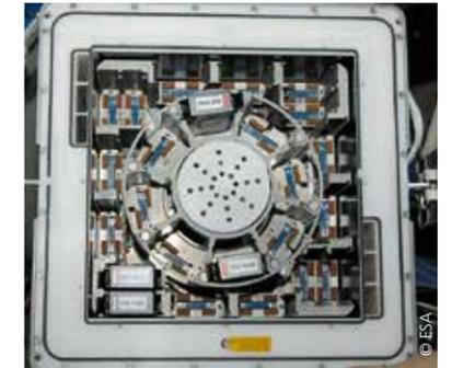
Im KUBIK-Inkubator im russischen Teil der Raumstation wurde das AT-Space-Experiment durchgeführt.
