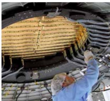
Ein Techniker prüft den Silizium-Spuren-detektor.
