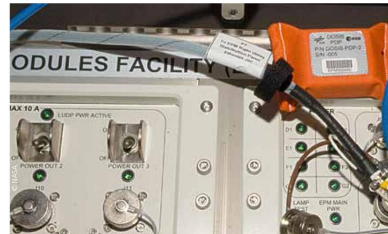
Passiver Strahlungsdetektor im europäischen Columbus-Modul
