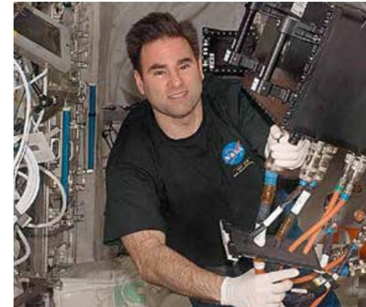
Astronaut Greg Chamitoff installiert den GeoFlow-Experimentcontainer im Columbus-Modul der Raumstation.
