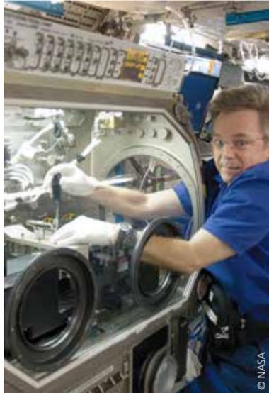
Der kanadische Astronaut Robert Thirsk installiert die SODI-Apparatur in der Microgravity Science Glovebox (MSG) im Columbus-Modul.
