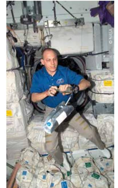
Astronaut Clay Anderson sammelt mit einer Pumpe Luftproben, die vom Analyzing Interferometer for Ambient Air (ANITA) im Unity-Verbindungsknoten analysiert werden.
