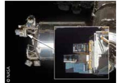
Die Experimentanlage Expose-EuTEF (European Technology Exposure Facility) an der Außenseite des europäischen Columbus-Labors
