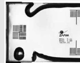
Flüssigkeiten strömen in Schwerelosigkeit bis zu einer bestimmten Geschwindigkeit unbeeinträchtigt konstant. Wird der Saugdruck der Pumpe soweit erhöht, so dass die Strömungsgeschwindigkeit ein bestimmtes Maß überschreitet, dann bilden sich am Rand der Apparatur Blasen und der Flüssigkeitsstrom reißt ab.
