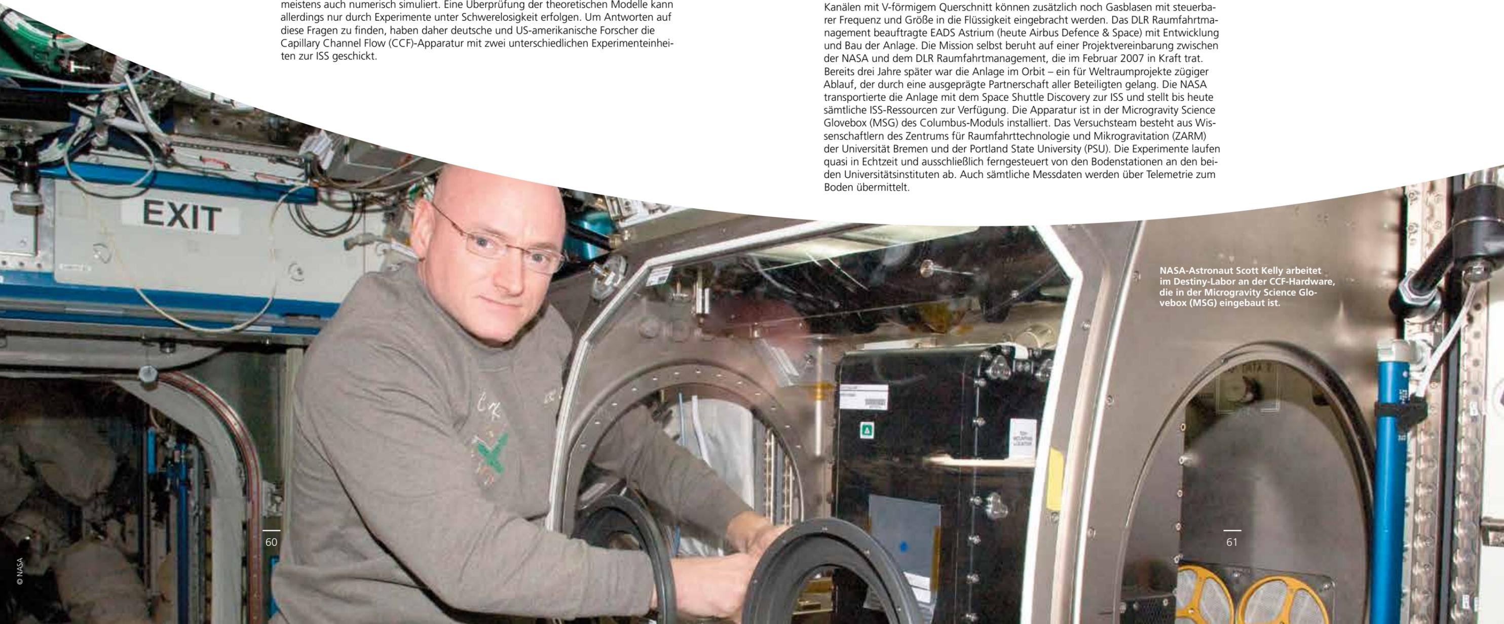
NASA-Astronaut Scott Kelly arbeitet im Destiny-Labor an der CCF-Hardware, die in der Microgravity Science Glovebox (MSG) eingebaut ist.
