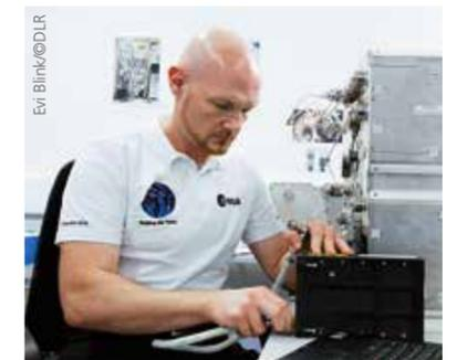
In der Schwerelosigkeit werden Legierungen zukünftig behälterfrei mit der EML-Anlage geschmolzen. Der deutsche ESA-Astronaut Alexander Gerst trainiert am EAC in Köln, wie sie funktioniert. Er wird EML auf der Raumstation in Empfang und in Betrieb nehmen.
