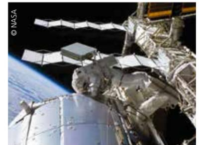
Die Astronauten John Olivas and Nicole Stott demontieren am 1. September 2009 in einem sechseinhalbstündigen Außenbordeinsatz die Expose-EuTEF (European Technology Exposure Facility) mit den Expose-E-Proben, um sie zur Erde zurückzubringen.
