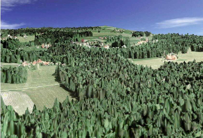
3-D-Darstellung des Stadtwaldes von Traunstein. Die Waldhöhen wurden aus Radardaten mit Hilfe der polarimetrischen SAR-Interferometrie gewonnen.
