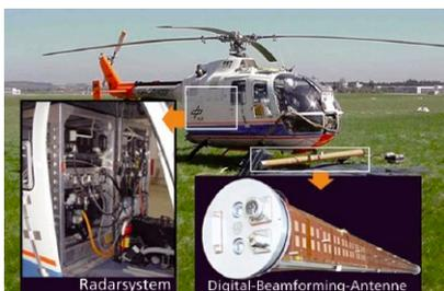
Digital-Beamforming-Demonstrator auf einem DLR-Hubschrauber
