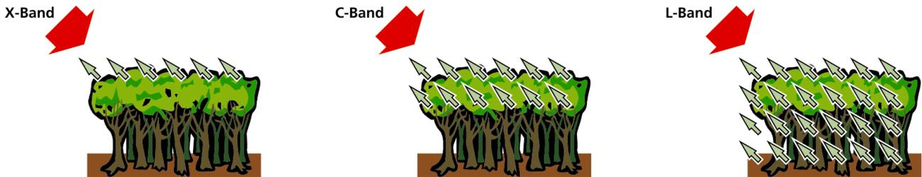
Vergleich der Eindringtiefe von X-, C- und L-Band mit 3 cm, 5 cm und 24 cm Wellenlänge bei Vegetation. Während Radarwellen im X-Band nur von der oberen Baumkrone reflektiert werden, dringt das L-Band bis zum Boden. Nur L-Band-Radarsysteme können Signale aus allen Bereichen der Vegetation empfangen.
