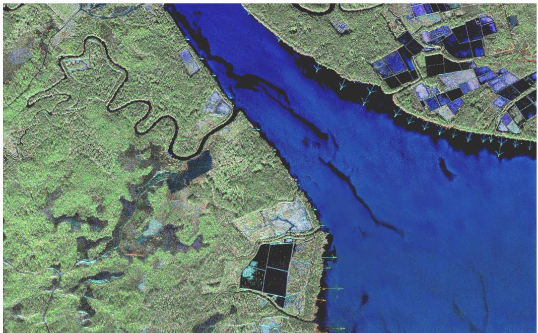
Flussmündung bei Balikpapan, Indonesien. Deutlich erkennbar sind die Shrimp-Zuchtbecken innerhalb der umgebenden Mangrovenwälder. Das vollpolarimetrische L-Band-Radarbild wurde im November 2004 mit dem flugzeuggetragenen SAR-System des DLR aufgenommen.
