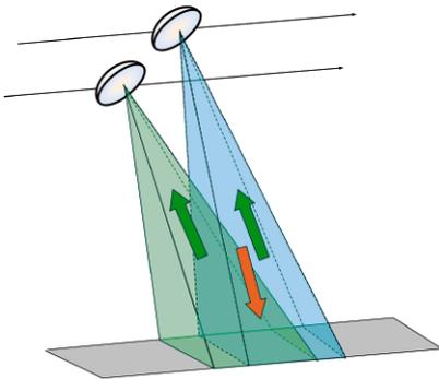
Die simultane Datenakquisition mit zwei vollpolarimetrischen Radarsatelliten im L-Band ermöglicht die Aufnahme einzigartiger Datenprodukte für ein breites Spektrum wissenschaftlicher Anwendungen.
