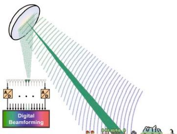
Einsatz innovativer Technologie bei Tandem-L. Die Technik des Digital Beamforming für hochauflösende Radarsysteme wurde in enger Kooperation zwischen dem DLR und der Industrie in Deutschland entwickelt und patentiert.
