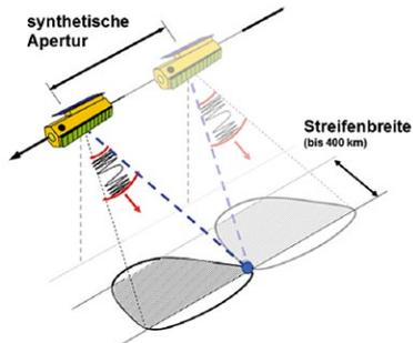
Das Radar mit Synthetischer Apertur (SAR). Die Bildung einer synthetischen Apertur mit mehreren Kilometern Länge ermöglicht eine hohe räumliche Auflösung, unabhängig von der Entfernung zum Ziel.
