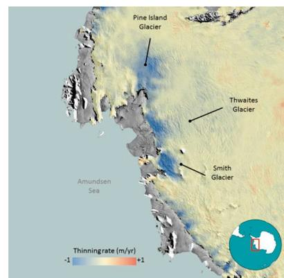
Von 2011 bis 2013 verlor der west-antarktische Eisschild jährlich mehr als 150 Kubikkilometer Eis. Die Abbildung zeigt Änderungen der Eishöhe, die vom ESA-Altimeter CryoSat gemessen wurden. Tandem-L wird eine kontinuierliche Beobachtung der Eisschilde mit hoher räumlicher und zeitlicher Auflösung erlauben.
