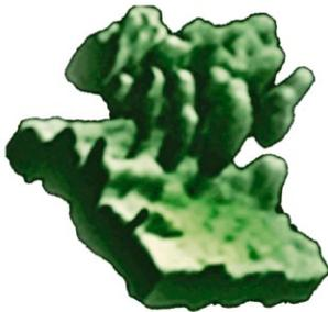
Demonstration der tomografischen Abbildung einer Baumgruppe im L-Band. Für dieses Beispiel wurden die Radardaten vom Flugzeug-SAR-System des DLR durch mehrfache Überflüge im Abstand von wenigen Minuten aufgenommen.
