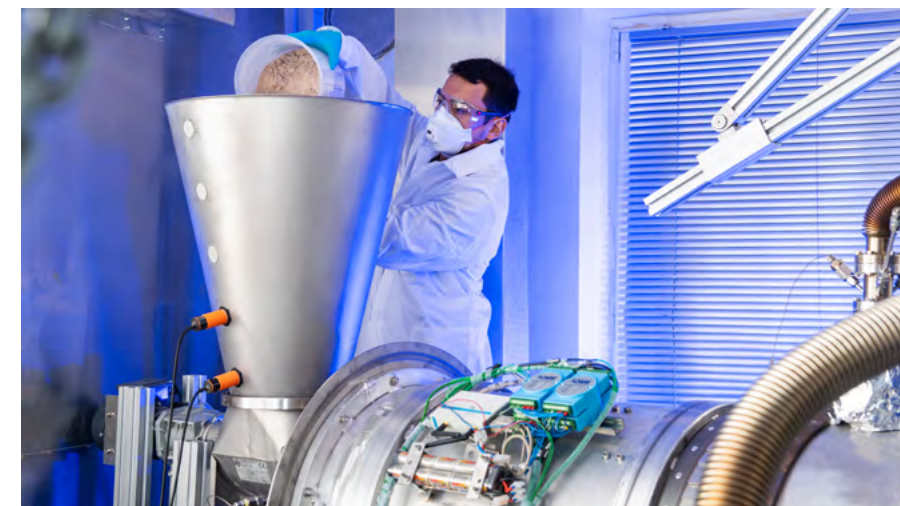
Im Hochleistungsstrahler in Köln testeten Forschende des DLR erfolgreich die solare Kalzinierung von Zementrohmehl, als Teilschritt der Zementherstellung. Bild: DLR
