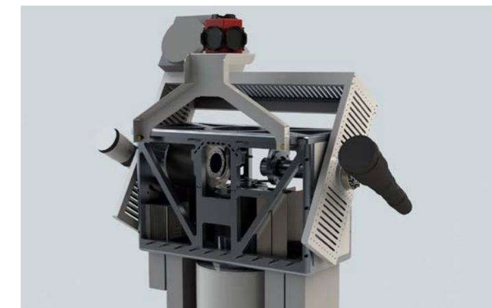
Modell der Schwenk- und Neigeplattform zur Identifikation und genauen Bahnbestimmung von Drohnen
