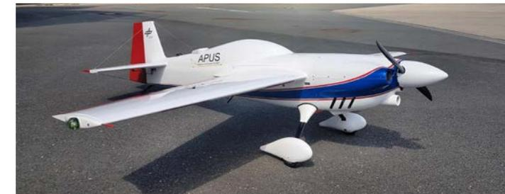
APUS, stark motorisierter Forschungsträger zum Schleppen einer Koppereinheit
