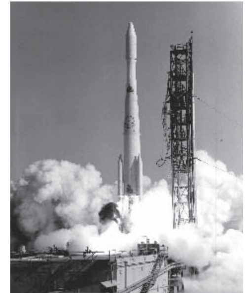
Der von Messerschmidt Bölkow Blohm konstruierte Heos-1 Satellit verließ am 5. Dezember 1968 an Bord einer Delta-Rakete von Cape Canaveral aus die Erde. Er untersuchte Weltraumstrahlung, den Sonnenwind und Magnetfelder. (NASA)
