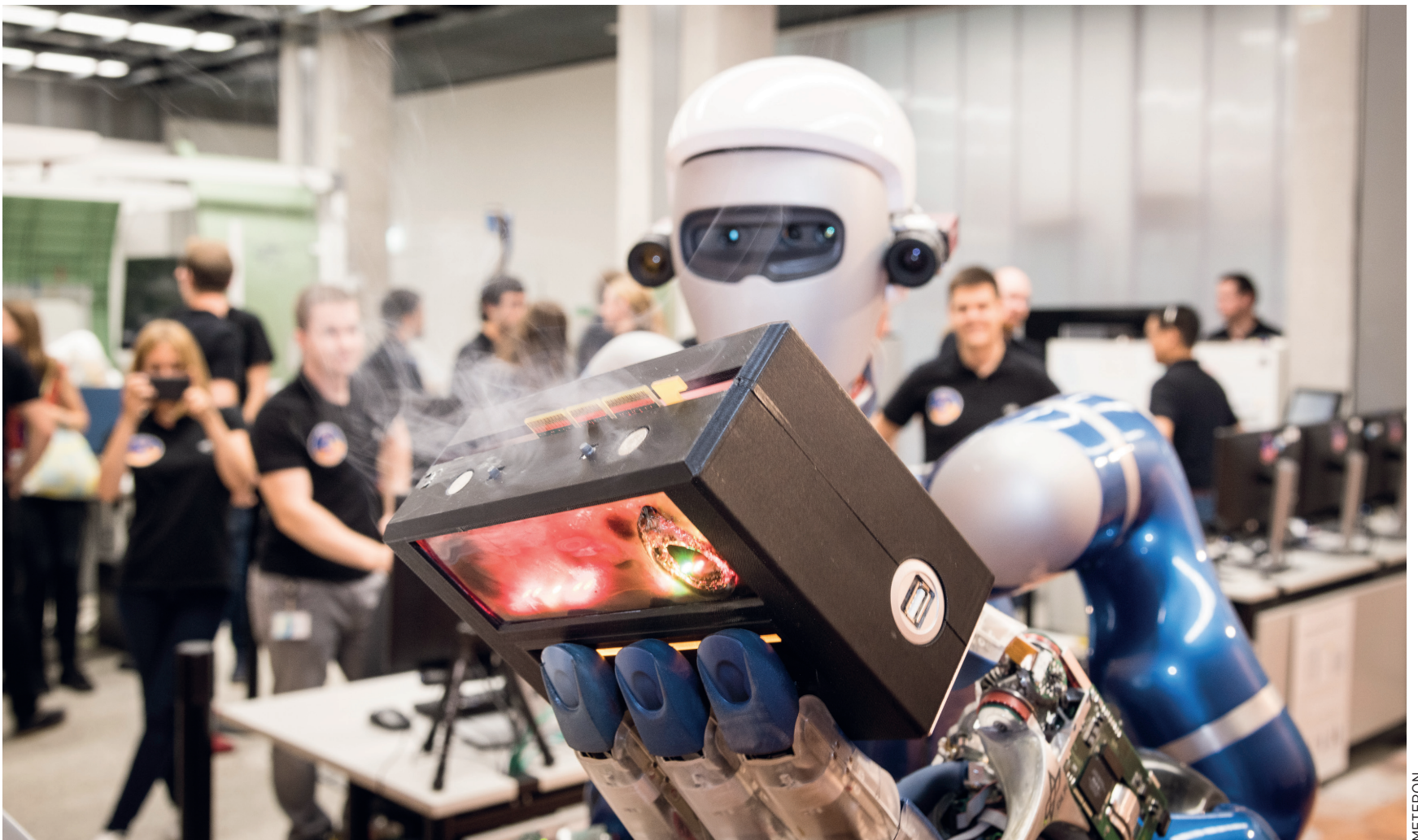
Im METERON-Projekt steuerte der deutsche Astronaut Alexander Gerst an Bord der Internationalen Raumstation ISS den humanoiden Roboter Rollin' Justin im DLR Oberpfaffenhofen weitgehend ohne Kontakt zur Bodencrew. Hier tauscht Justin ein defektes Kommunikationsmodul aus.
